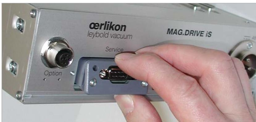
Fig. 4.3 Inserting the module
